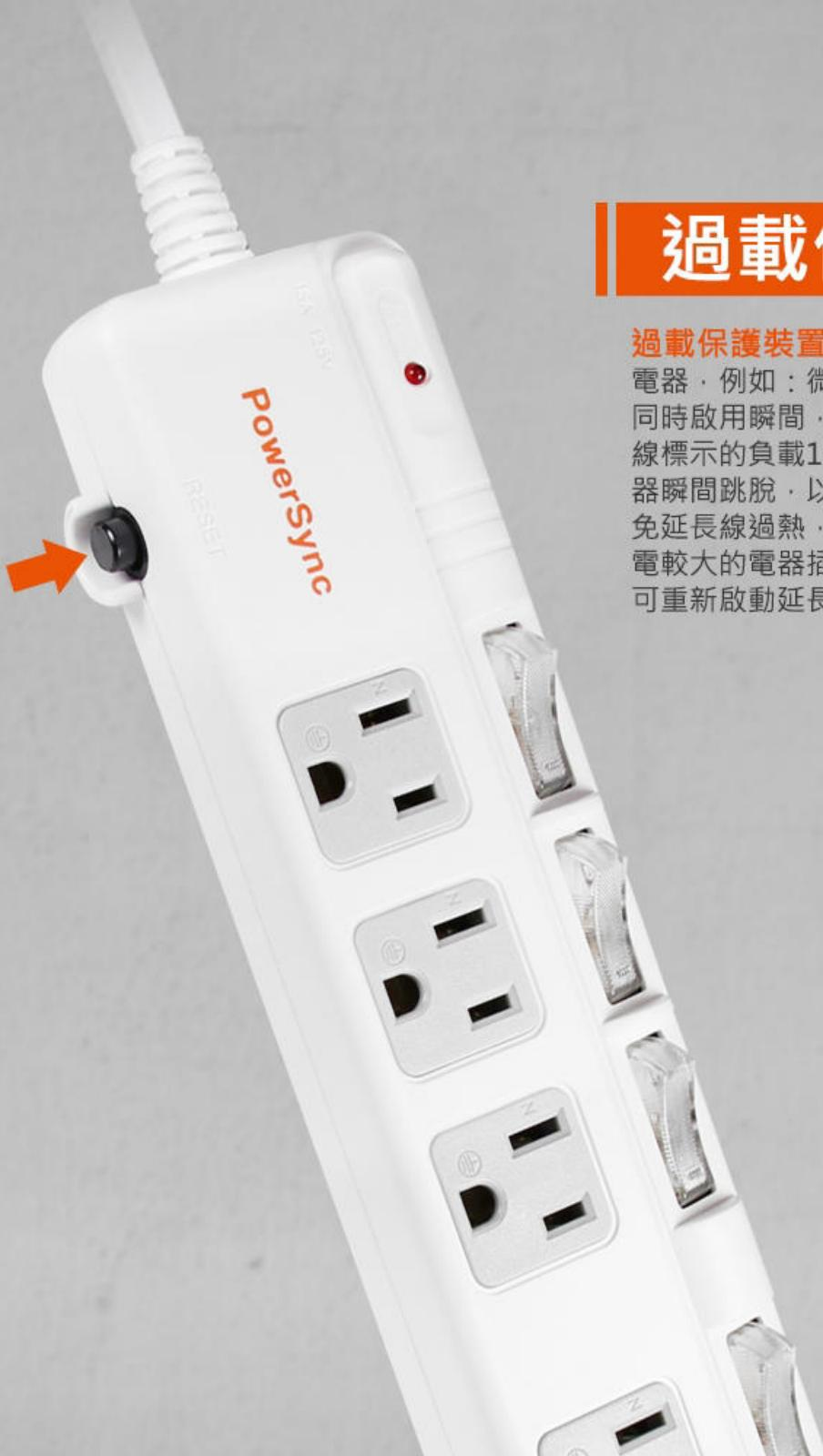
**過載保護裝置**當延長線後方插入太多電器，例如：微波爐、烤箱、電鍋，而同時啟用瞬間，電流超過一般電源延長線標示的負載15A/1650W，過載保護器瞬間跳脫，以保護後端電器產品，避免延長線過熱，電線走火。只要移除用電較大的電器插頭後，按下黑色按鈕即可重新啟動延長線。
